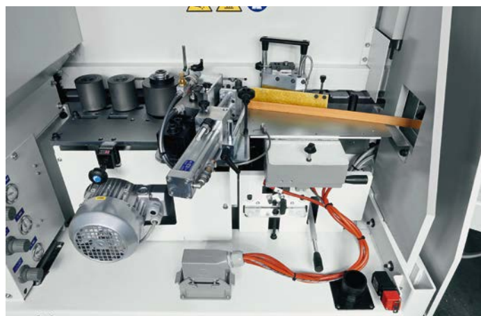
Кромкооблицовочный станок с нижним расположением клеевой ванны. Фото предоставлено компанией «МДМ»
