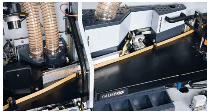
Клеевой узел glueBox на станке Format4 tempora. Фото предоставлено компанией FELDER GROUP RUSSIA
