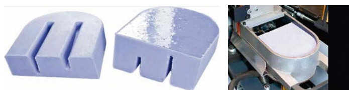
Силиконовая вставка в клеевую ванну Felder, уменьшающая минимальный объем используемого клея
