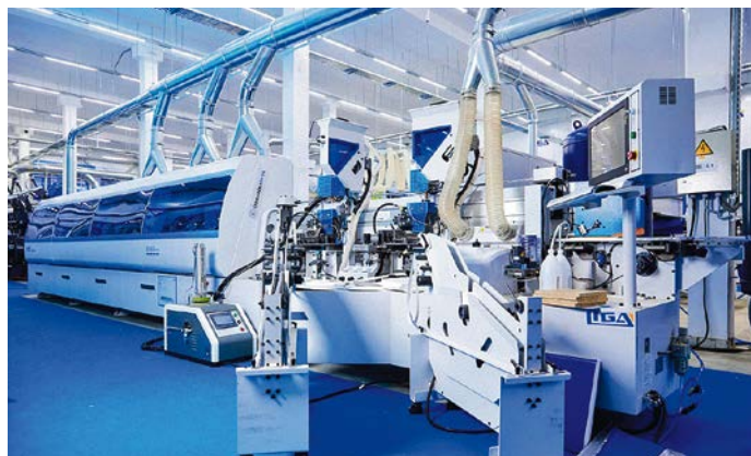
Кромкооблицовочный станок со станцией плавления клея и двумя бункерами с предплавителями. Фото предоставлено компанией LIGA
