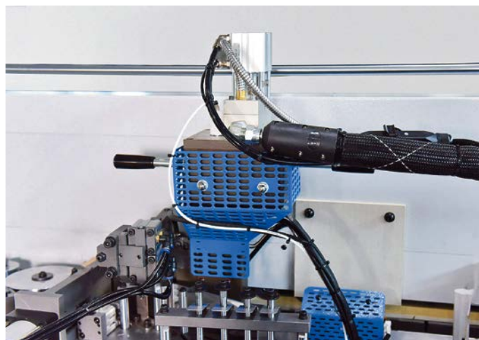
Верхняя клеевая ванна с подведенным от станции плавления PUR-клея подогреваемым шлангом. Фото предоставлено компанией LIGA
