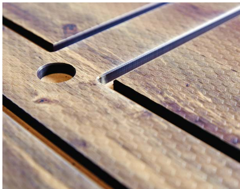
HPL-пластик, обработанный алмазной фрезой Surrey за один проход
