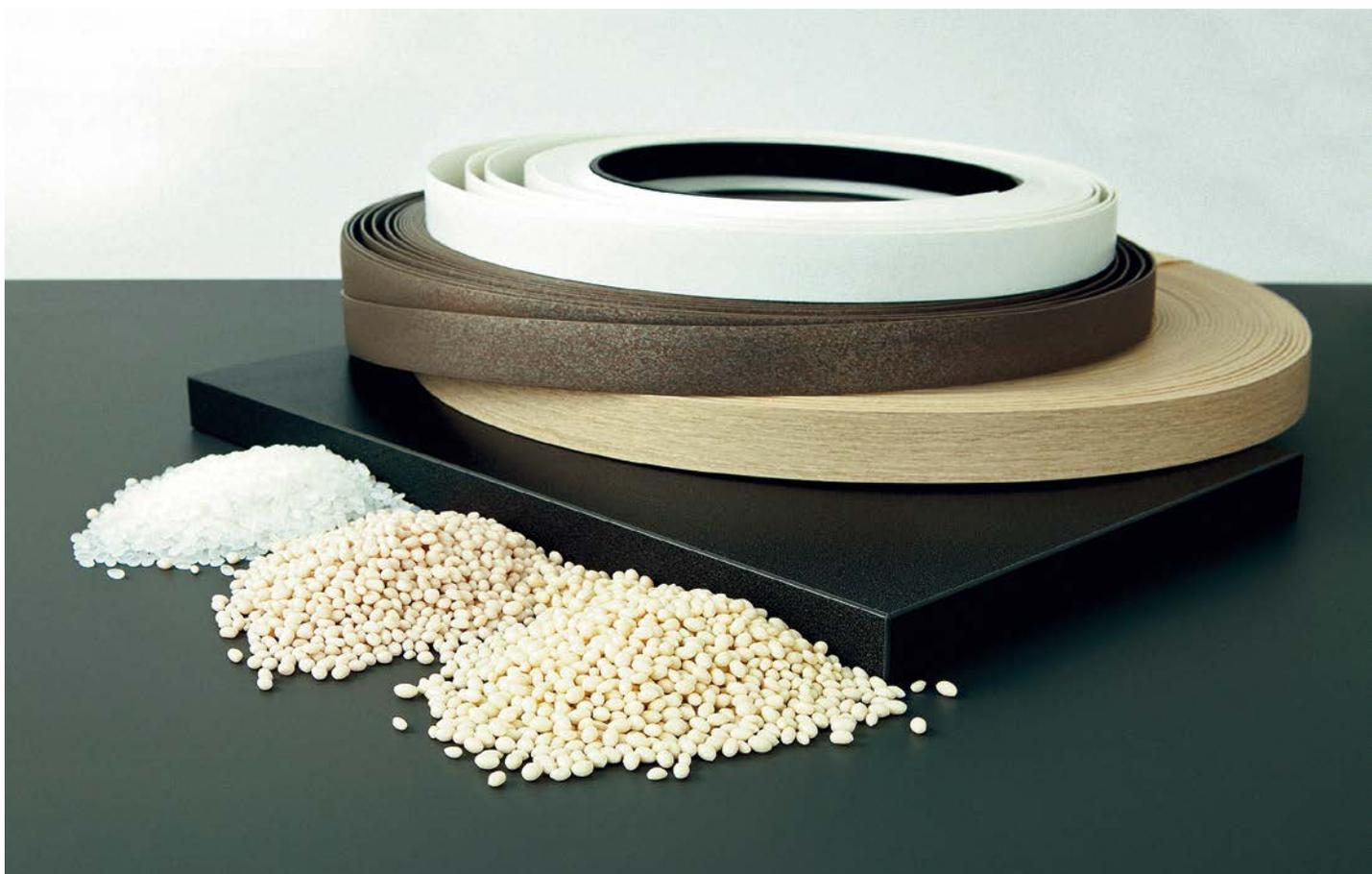
За развернутой информацией приглашаю на сайт журнала. Но если сделать короткую выжимку, то полиолефин (ПО) — это такой же термопластичный клей, как и EVA (этиленвинилацетат). То есть, при нагревании он размягчается, а при остывании твердеет. И этот цикл может повторяться много раз. Такое поведение сильно упрощает переработку клея, потому что его можно надолго оставлять в клеевой ванночке станка.
