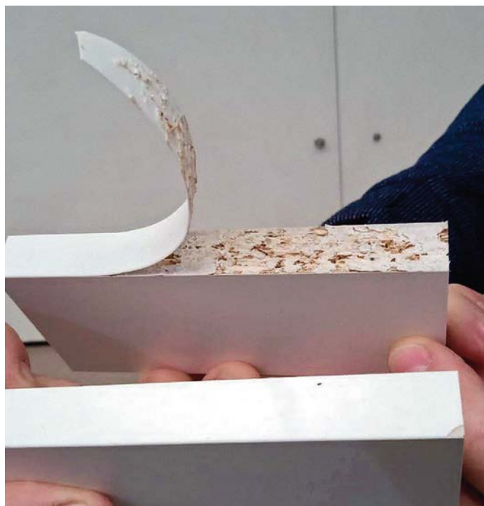
Натурные испытания стойкости EVA и PUR к обработке горячим паром, LIGA
